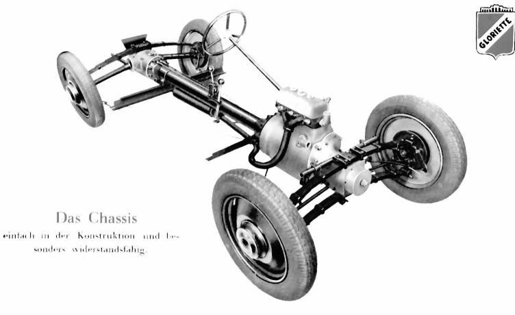
MOTOR: Elastischer Vierzylinder-Viertaktmotor mit Wasserkühlung (Thermosyphon), Bohrung und Hub 58 x 75 mm, Zylinderinhalt 795 ccm, Leistung 20 PS bei 3200 Umdrehungen in der Minute. Hängende Ventile, Leichtmetallkolben, Kugelgelagerte Kurbelwelle. Zylinder und Kurbelgehäuse aus Siluminguß mit auswechselbaren Zylinderlaufbüchsen aus chromlegiertem Grauguß, dadurch günstige Wärmeabfuhr. Druckumlaufschmierung mit ventil-
