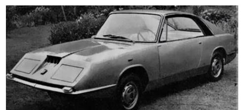
Die beiden Doppelscheinwerfer wurden versenkbar entwickelt, es sollte einen optischen Effekt garantieren. Die zum Heck gezogene übergroße Heckscheibe könnte geöffnet werden und gab den Kofferraum frei.
