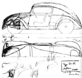
Am 18. Jänner 1936 skizzierte Komenda seinen ersten Wagen für das Volk. Es war eine Stromlinienform mit separat verschraubtem Kotflügel. Ein sehr modernes Design für diese Zeit. Bereits 1937 wurden 30 Vorserienkarosserien bei Daimler-Benz im Karosseriewerk Sindelfingen gebaut. Dazu gehörten 29 Limousinen und ein Cabrio, die jeweils mit einem vollen Stahlkörper, ohne Heckscheibe durch einen luftgekühlten 22PS 4-Zylinder Motor im Heck angetrieben wurden.
